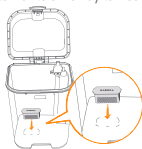
Depósito de agua limpia
