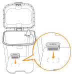
خزان المياه النظيفة
